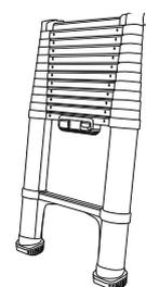
Pour déployer l'échelle, assurer sa stabilité en posant un pied sur le barreau inférieur et tirer vers le haut sur les deux montants supérieurs. Déployer l'échelle complètement.
