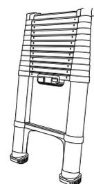
Under udtrækning af stigen skal du anbringe en fod på det nederste trin for at opnå ekstra stabilitet og først trække de to øverste vanger ud. Træk stigen helt ud.
