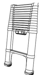
Podczas wyciągania drabiny dla dodatkowej stabilności należy oprzeć jedną stopę na najniższym szczeblu i najpierw wyciągnąć obie górne podłużnice. Wyciągnąć całkowicie drabinę.
