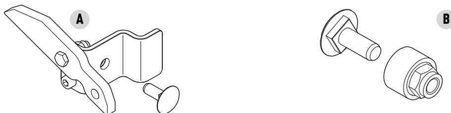
Die Schienensperren verhindern beim Ein- und Aussteigen aus dem Steigschutz-System ein unbeabsichtigtes Herausziehen oder Herausfallen des Sicherungsläufers aus der Steigschutzschiene.
